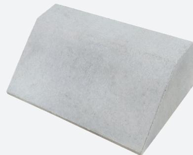
**Flachbord LP Fix** ist ein Bordsteinsystem, das für das Aufkleben auf Asphalt- oder Betonfahrbahnen entwickelt wurde. Die wirtschaftliche und schnelle Bauweise der Bordsteinklebetechnik wird bevorzugt eingesetzt, wenn Aufgrabungen und Tiefbauarbeiten an den Fahrbahndecken vermieden werden sollen.
